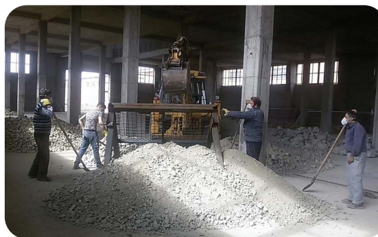
شکل ۸- آماده‌سازی و دانه‌بندی نمونه‌ها
