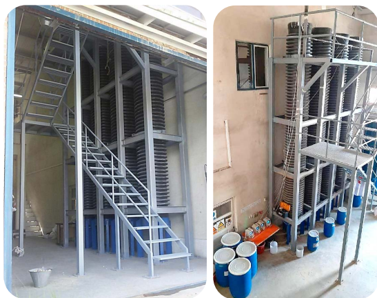
شکل ۱۱- ستون‌های شش متری آزمایش‌های پایلوت لیچینگ سونگون
